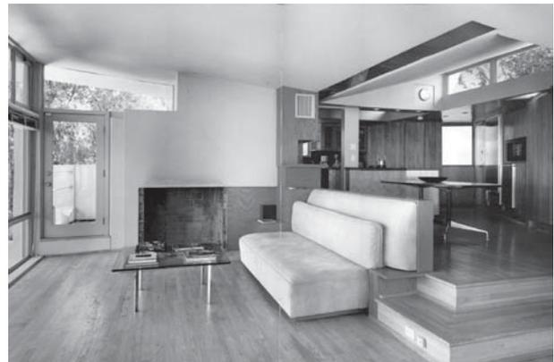
Figura 07 - esta cena mostra bastante sobre a busca de conforto através do domínio sobre a espacialidade: vão amplo, paredes finas, estrutura flexível, aberturas ‘em clerestório’ e diferenças de nível na planta, com compartimentos com pé-direitos próprios conforme especificidades (raumplan). Imagem da Residência Wilson, Los Angeles, 1935-39. Fonte: Steele, 2001.
